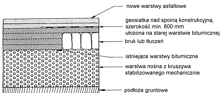
Rys. 4. Wzmocnienie nawierzchni asfaltowej w strefie zmiany konstrukcji nawierzchni
